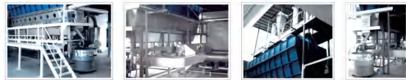
实际使用中的非标设计大型沸腾床 Fluidizing dryers under production on-site
